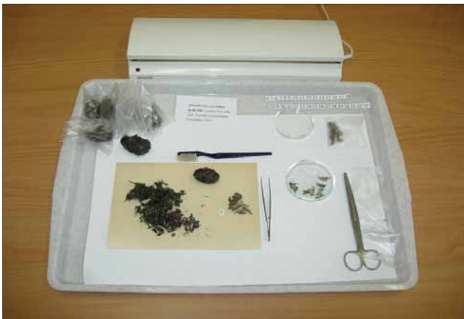
Slika 4.: Pribor za čišćenje gvalica i pakiranje ostataka plijena (Foto: Jenő J. Purger)
